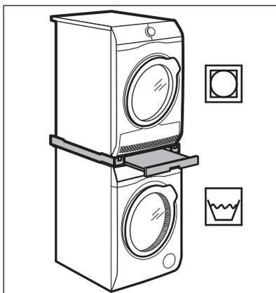
Le sèche-linge ne peut-être superposé au-dessus du lave-linge **qu'en utilisant le kit de superposition adapté, fabriqué et agréé par AEG.**
