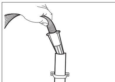
5. Sans le guide de tuyau en plastique : Placez le tuyau de vidange dans le siphon et serrez-le avec une attache. Reportez-vous à l'illustration.
